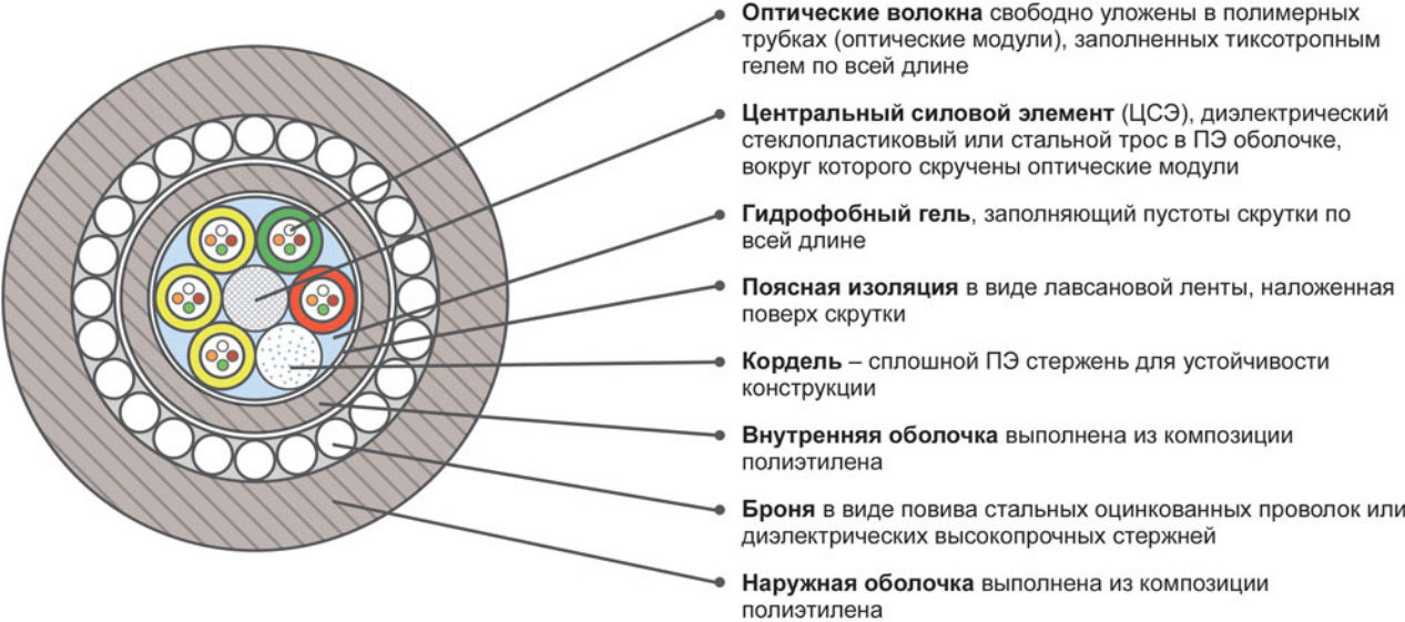
Конструкция ОКЛК, содержащая до 48 ОВ
