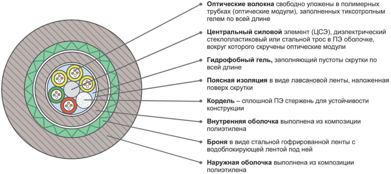
Конструкция ОКЛСт с двумя ПЭ оболочками, содержащая от 24 до 48 ОВ
